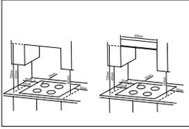
O distanță minimă de 400 mm să fie lăsată între marginile laterale ale plitei și orice materiale combustibile.
